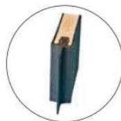
**Núcleo Aislado** – El núcleo de uretano espumado en su lugar sin clorofluorocarbonos de alta densidad asegura una unión fuerte entre el núcleo y a piel exterior, lo que abate el ruido y da una separación térmica con un factor R de 9.86.
